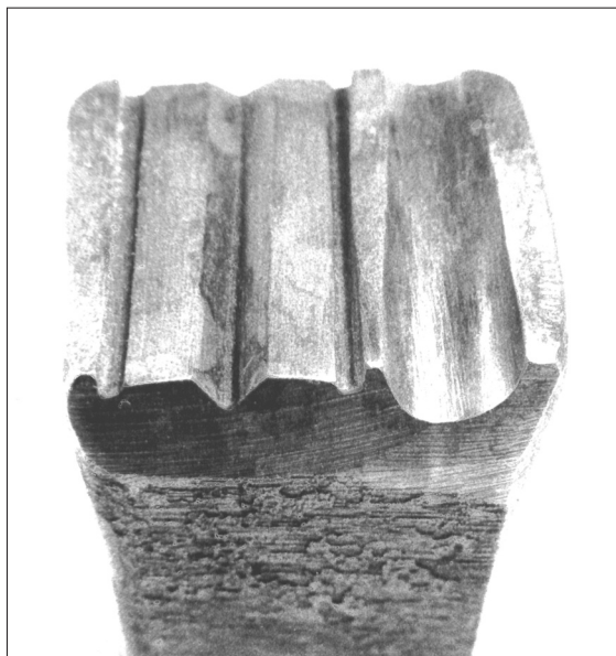
Fig. 18. Żelazny kształtownik z negatywem wzoru ramy skandynawskiej bransolety – „pierścienia” typu A-C oraz kształtownik tulejowy do obkuwania i zwężania sztabek surowca.
