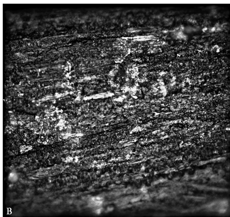
Ryc. 3. Materiały eksperymentalne: 1 – narzędzie do obróbki wapienia; 2 – narzędzie do obróbki piaskowca. A, B – ślady mikroskopowe, pow. \times 200 (ob. \times 10 ) (rys. P. Rozbiegalski, fot. K. Pyżewicz).
